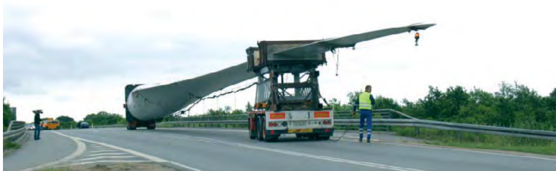
Specialtransporter for store vindmøller - særligt møllevinger - kræver trafikale foranstaltninger. Foto: LM Glasfiber
